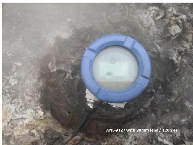
*Note: 经验表明对于发射频率较高的物位雷达，无论蒸汽如何，使用更大的透镜天线在这方面都具有优势。*
