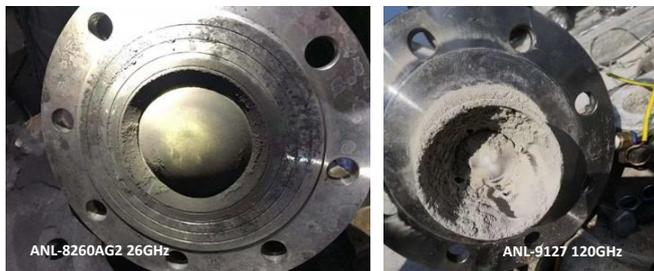
但对于 80GHz 波段的雷达，就不具备这个特征，冷凝对于小透镜的 80GHz 物位雷达影响是灾难性的，多数冷凝状态下测量是不稳定的（下图所示）。
